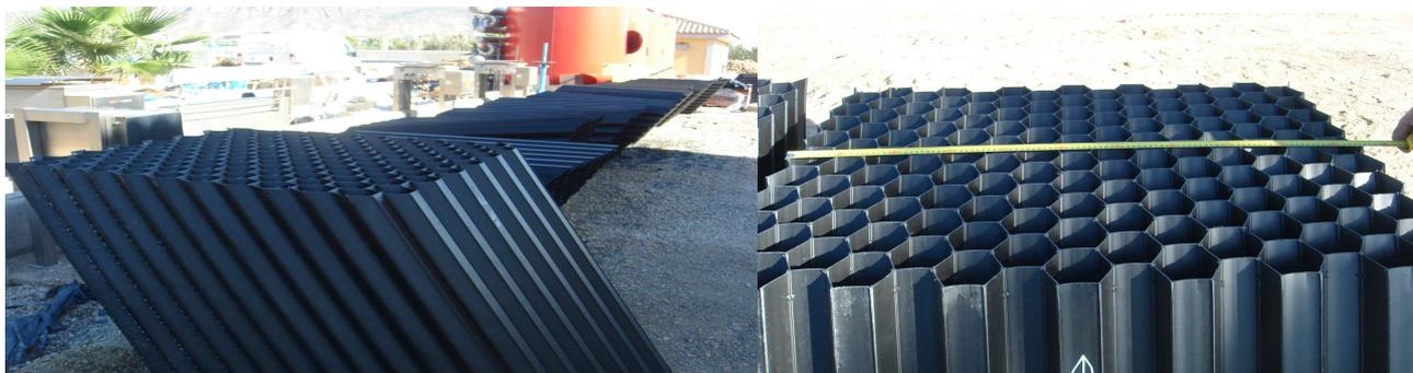
Los lamelares TecnoConverting con un espesor  $> 1$  mm se ensamblan mediante ultrasonidos con el sistema de refuerzo por puntos, con este sistema se dota a cada perfil lamelar de al menos 5 puntos de soldadura. Con esta técnica se consigue una gran rigidez en los lamelares, facilita su instalación en los decantadores y asegura una gran durabilidad del mismo.
